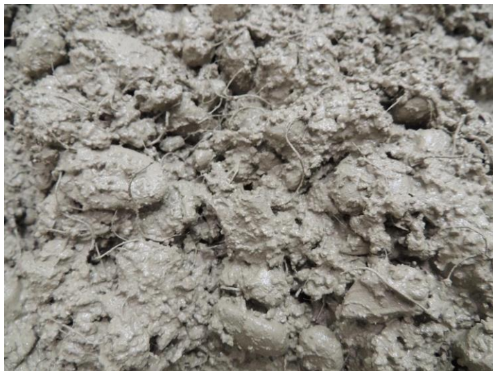
Detalle de un hormigón fibroreforzado con la fibra polimérica estructural MAPEFIBRE ST50 TWISTED .
