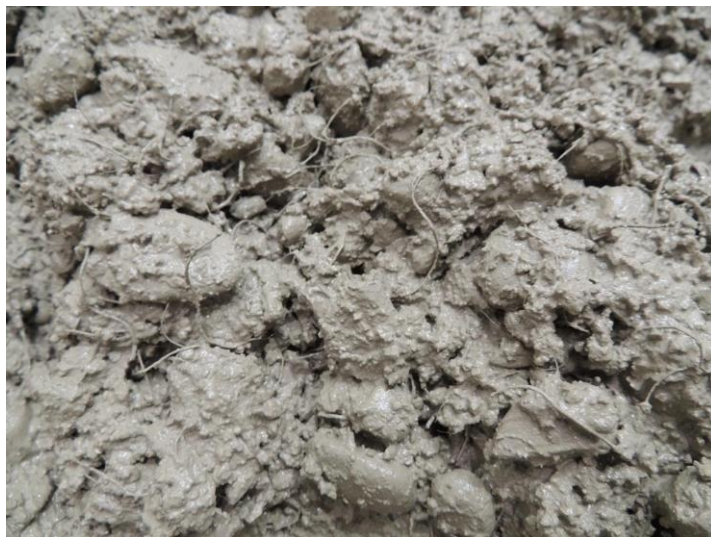
Detall d'un formigó fibroreforçat amb la fibra polimèrica estructural MAPEFIBRE ST50 TWISTED .
