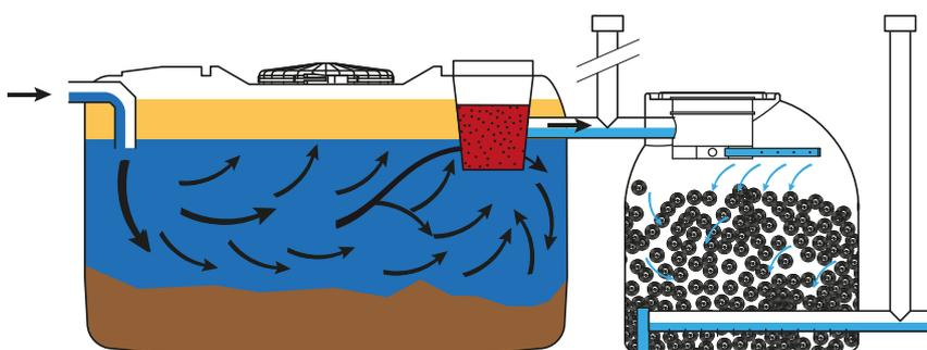
Conjunto autónomo de depuración biológica aeróbica de aguas residuales domésticas. Consta de una decantación primaria y un filtro percolador. Productos biológicos incluidos para la puesta en marcha. Rendimientos teóricos de eliminación de M.E.S del 90% y de DBO<sub>5</sub> del 76%.
