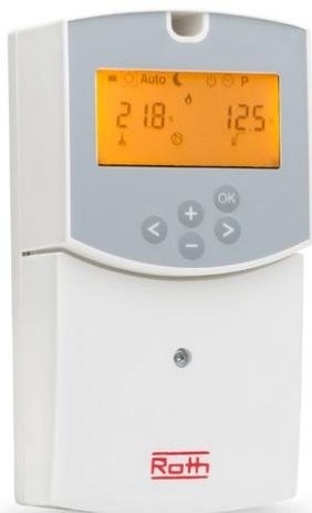
Se encarga de controlar la temperatura de impulsión en un sistema de calefacción por suelo radiante en función de la temperatura exterior, mediante una válvula mezcladora de 3 vías motorizada.
