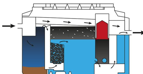
Los separadores de hidrocarburos Rothidro depuran las aguas contaminadas con aceites minerales e hidrocarburos y las aguas provenientes de limpiezas y escorrentías. El equipo incorpora un by-pass para que las aguas torrenciales no entren en la cámara de acumulación de hidrocarburos, ya que son aguas que no precisan de tratamiento. Para parkings, lavaderos de vehículos...
