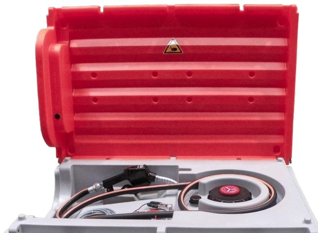
El surtidor incluye de serie un grupo de trasvase eléctrico (DC), una pistola automática con manguera de presión de 4 metros de longitud y 19 mm diámetro, un cable de 4 metros con pinzas de cocodrilo, un interruptor marcha/paro, una boca de llenado de 150 mm y una seta de ventilación.
