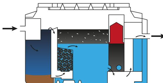
Los separadores de hidrocarburos Rothidro depuran las aguas contaminadas con aceites minerales e hidrocarburos y las aguas provenientes de limpiezas. Para estaciones de servicio, parkings, talleres...
