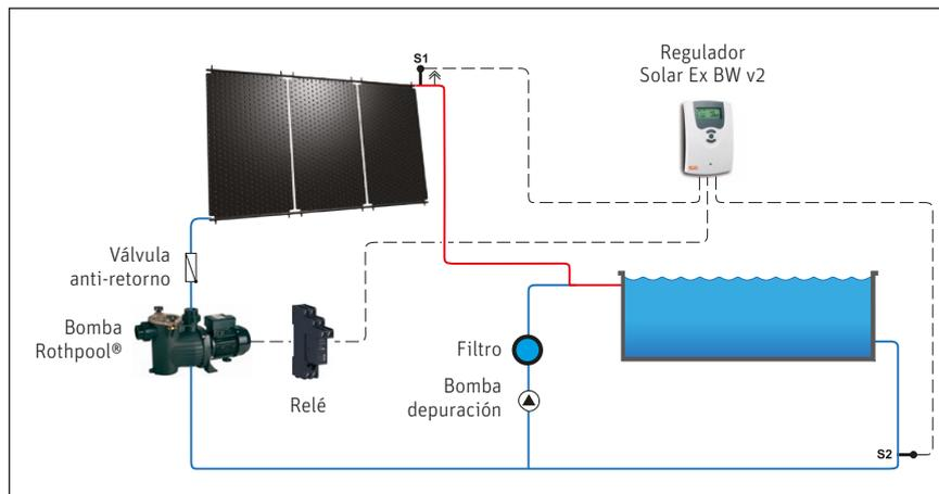
Instalación con dos bombas independientes para el circuito de filtración y campo de colectores Rothpool
