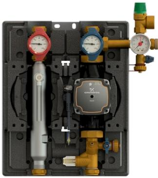
Unidad premontada con toda la valvulería necesaria, integrada en carcasa de EPP, altamente resistente con grupo de purga incluido. Formada por grifo de bola con válvula anti-retorno integrada, fijación a pared, grupo de seguridad con válvula de seguridad a 6 bar, manómetro de 0 a 10 bar, llaves de esfera de llenado y vaciado, incluidos elementos de montaje, circulador de alta eficiencia Grundfos UPM3PWM/7,5 cableado y probado.
