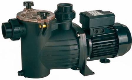
Diseñada especialmente para piscinas y compatible con el sistema de calentamiento Rothpool. Potencia 0,5 CV (0,37 kW). Con dos posibilidades de conexión hidráulica: rosca hembra 1 1/2" o tubo PVC Ø 50 para encolar.
