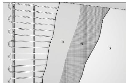
Montar el sistema de pared radiante siempre sobre una superficie rígida, lisa y libre de polvo.
